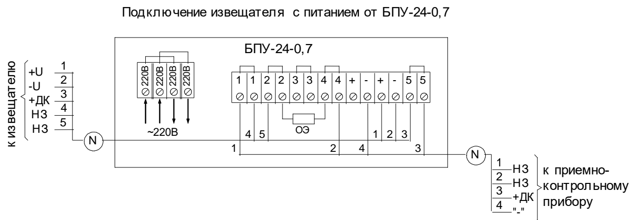
Рисунок 2.12 – Схема подключения извещателя к блоку питания «БПУ-24-0,7»
