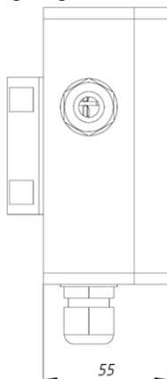
Рисунок 1.б - Коробка распределительная КР-2. Вид сбоку
