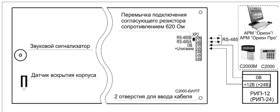
Рисунок 1. Схема внешних соединений блока «С2000-БИ SMD»
