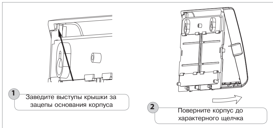
Рисунок 18. Установка крышки прибора «Сигнал-20М»
