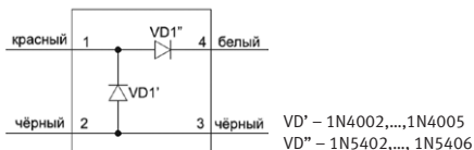
Рисунок 2. Схема внешних соединений прибора «С2000-АСПТ»
