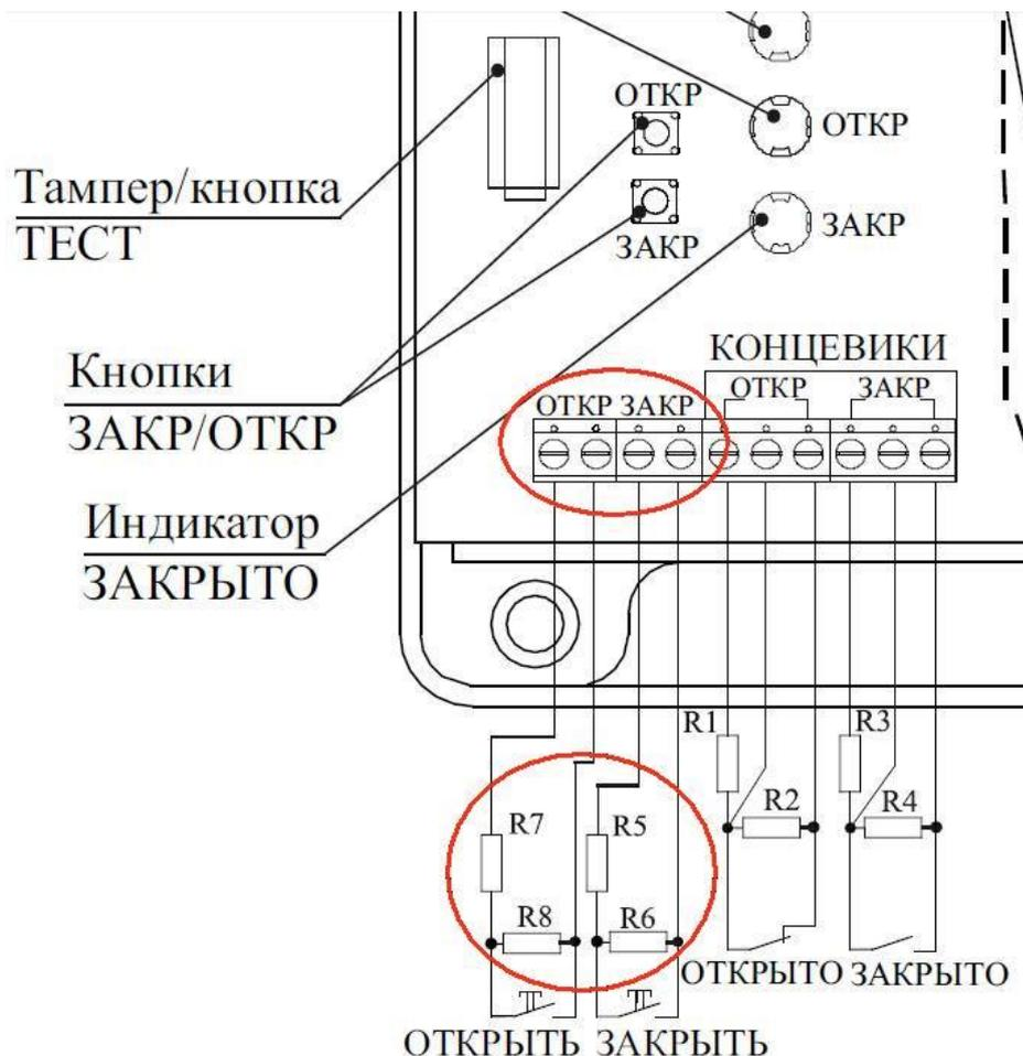
2. В случае управления огнезащитным клапаном с возвратной пружиной (в конфигурации МДУ-1С-Р3 тип привода – «пруж.»), начальное состояние – «откр.» наблюдается некорректная работа при управлении из сценария или через прибор Р3-Рубеж-2ОП. Для правильной работы клапана в случае пожара необходимо настроить систему таким образом:
