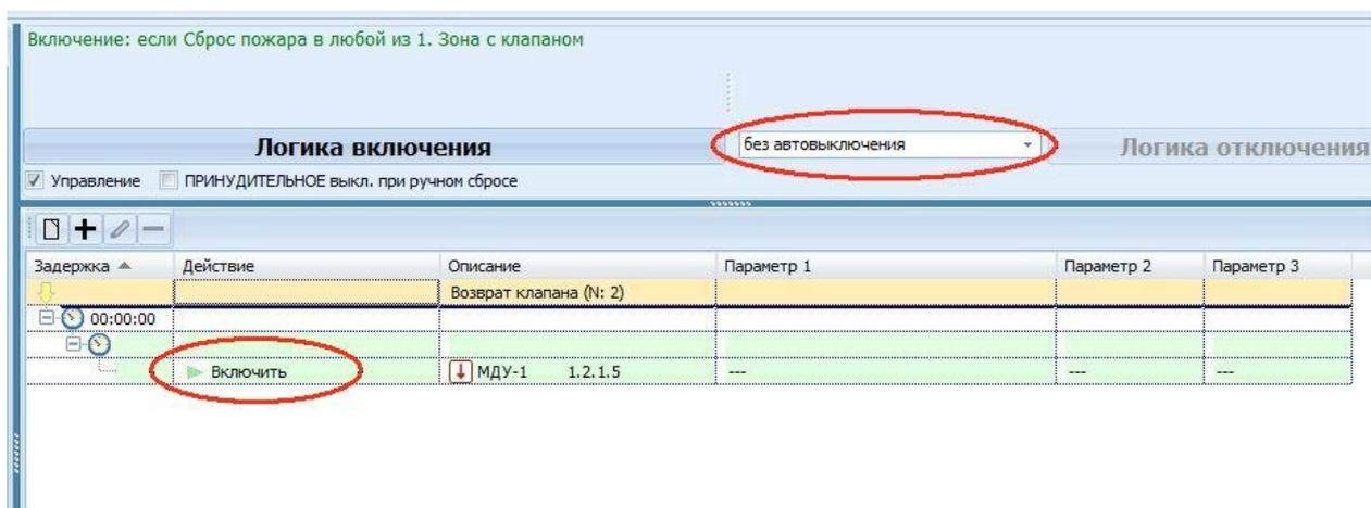
При ручном управлении клапаном через прибор R3-Рубеж-20П для закрытия клапана (перевести в сработку) необходимо нажать на клавиатуре прибора кнопку СТОП, для открытия клапана (перевести в норму) необходимо нажать на клавиатуре прибора кнопку ПУСК.
